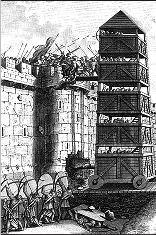
Рис. 1.7. Средневековая осадная башня — устройство для проникновения в крепость без разрушения ее стен
